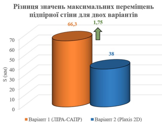
Рис. 12. Діаграма порівняння горизонтальних переміщень підпірної стіни для двох варіантів.
