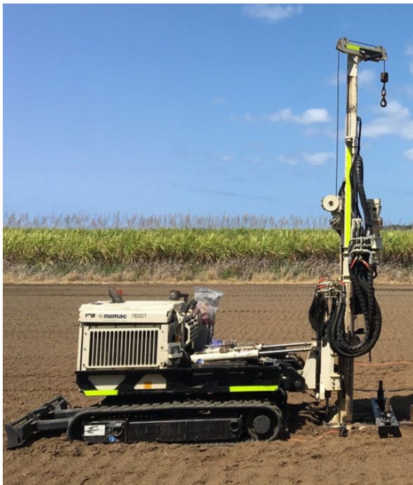
Рис.2. Машина CPTu. Fig.2. Cone penetration test machine
