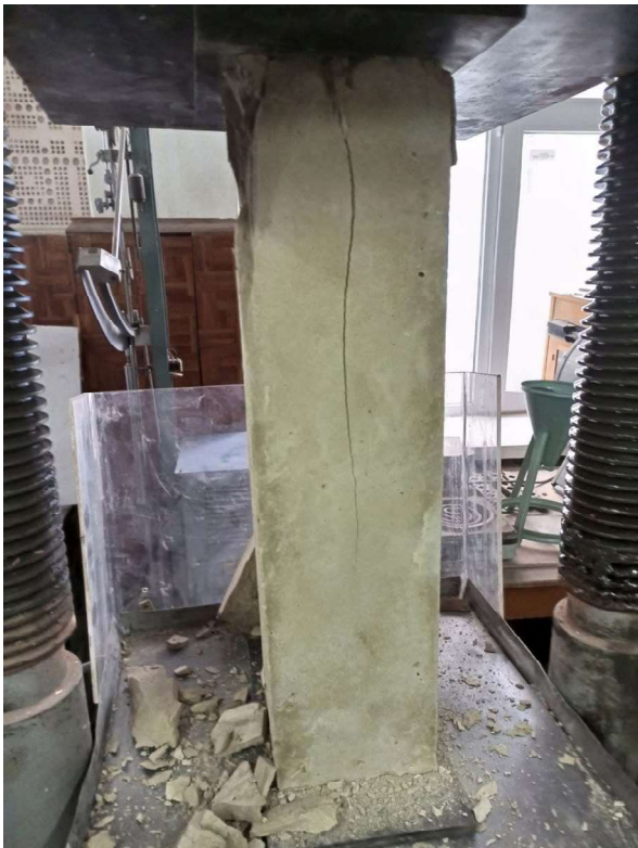
Рис. 4. Випробування призми на модуль деформації
