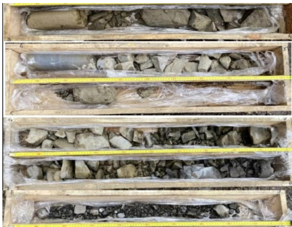
Рис.6. Керни флішових порід. Fig.6. Core samples of flysch rocks.
