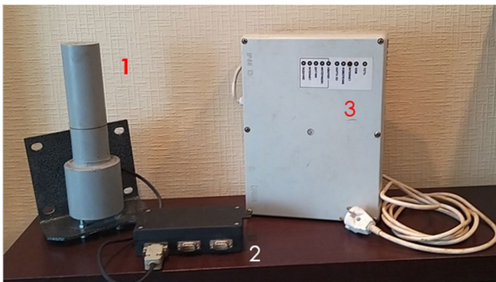
Рис. 3. Технічні засоби, що входять до ІТДББ: 1 - індуктивний датчик; 2 – вимірювач індуктивності; 3 - блок збору на передачі інформації.
