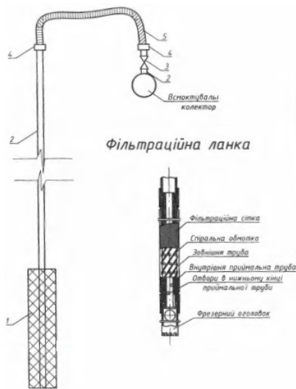
Рис. 5. Конструкції голкофільтру 1 – трубчастий каркас з щільною перфорацією; 2 – підкладочні повздовжні стержні; 3 – водоприймальна поверхня з дротової обмотки; 4 – підкладувальна обмотка; 5 – водоприймальна поверхня з нержавіючої сітки; 6 – водоприймальна поверхня з штампованого листа з отворами. Fig. 5. Needle filter designs. 1 – tubular frame with slot perforation; 2 – lining longitudinal rods; 3 – water-receiving surface made of wire winding; 4 – lining spiral winding; 5 – water-receiving surface made of stainless mesh; 6 – water-receiving surface made of stamped sheet with holes.
