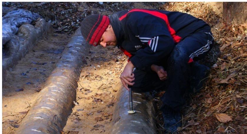
Рис.4. Процес вимірювання питомого опору зрушенню пенетрометром. Fig.4. The process of measuring shear resistance with a penetrometer.
