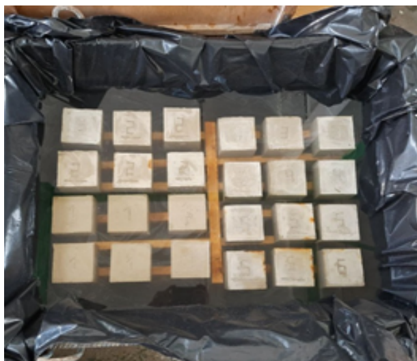
Рис. 3 – Витримування зразків у вологому середовищі
